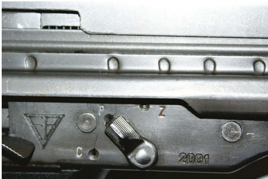
Fot. 4. Bezpiecznik – przełącznik rodzaju ognia pistoletu maszynowego PM-98
