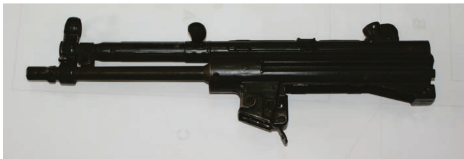
Fot. 15.1. Komora zamkowa z lufą, mechanizmem napinającym oraz przyrządami celowniczymi
