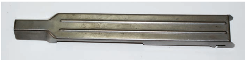
Fot. 3.1. Pokrywa komory zamkowej
