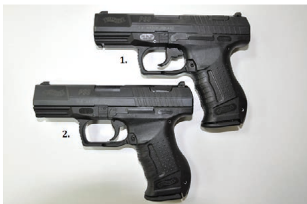
Fot. 2. Pistolet z językiem spustowym w pozycji DA (pkt 1) i pistolet z językiem spustowym w pozycji SA (pkt 2)
