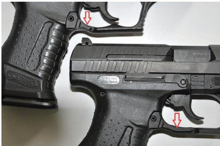
Fot. 11. Dźwignia zatrząsku magazynka
