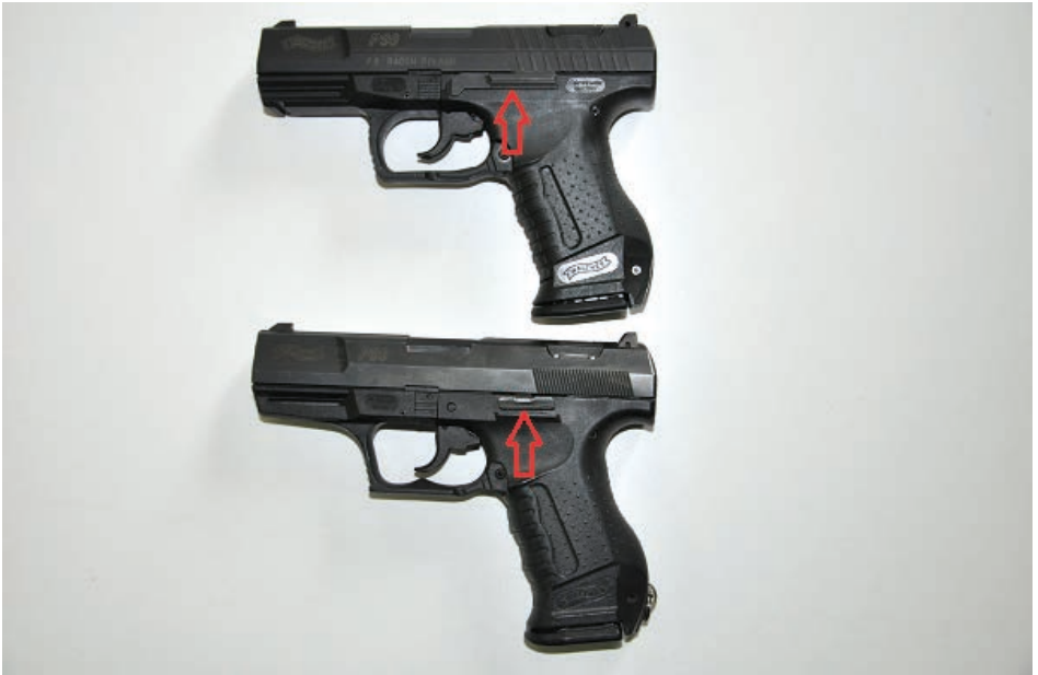
Fot. 10. Dźwignia zwalniania zamka – lewy profil pistoletu
