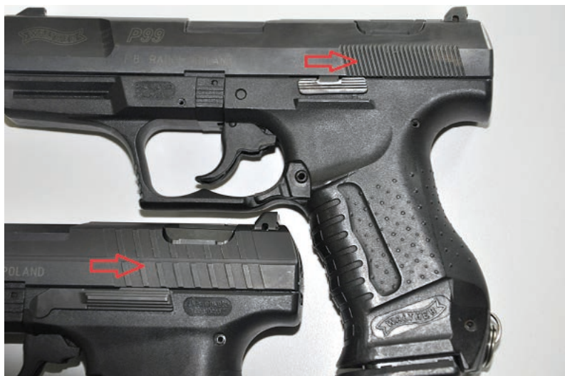
Fot. 11. Radełkowana powierzchnia zamka
