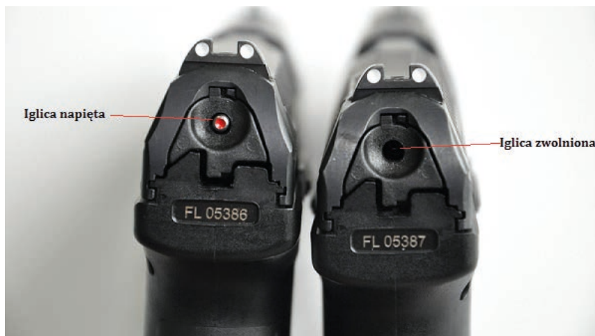
Fot. 13. Wskaźnik napięcia iglicy
