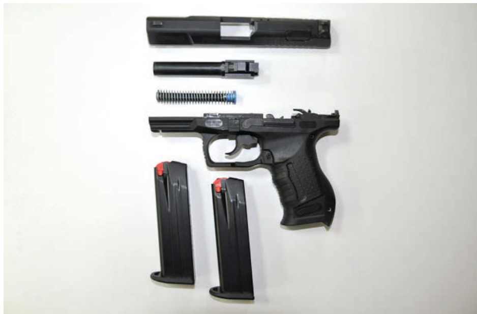
Fot. 3. Pistolet P-99 rozłożony na podstawowe elementy
