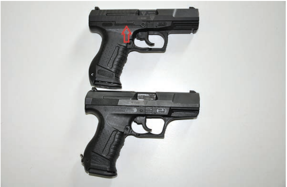
Fot. 11. Dźwignia zwalniania zamka – prawy profil pistoletu
