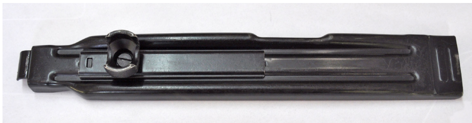
Fot. 6.2. Pokrywa komory zamkowej
