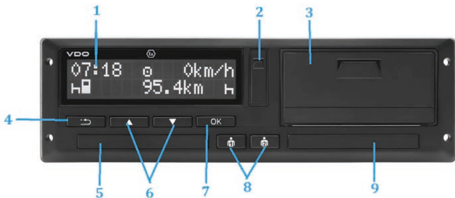
Rys. 3. Schemat budowy tachografu cyfrowego (źródło: http://fleet.vdo.com/products/dtco-30 )
