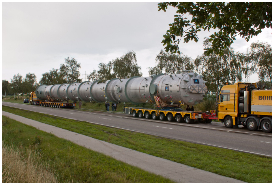
Rys. 8. Pojazd złożony składający się z dwóch ciągników oraz dwóch naczep niskopodwoziowych ośmioosiowych realizujący transport zbiornika o długości 30 m. Źródło: http://www.spedition-bohnet.de
