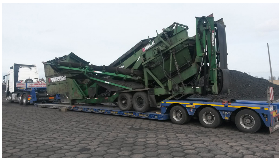
Rys. 20. Naczeпа tiefbett trzyosiowa z ładunkiem maszyny budowlanej o masie 30 t. Źródło: http://www.mich-trans.com
