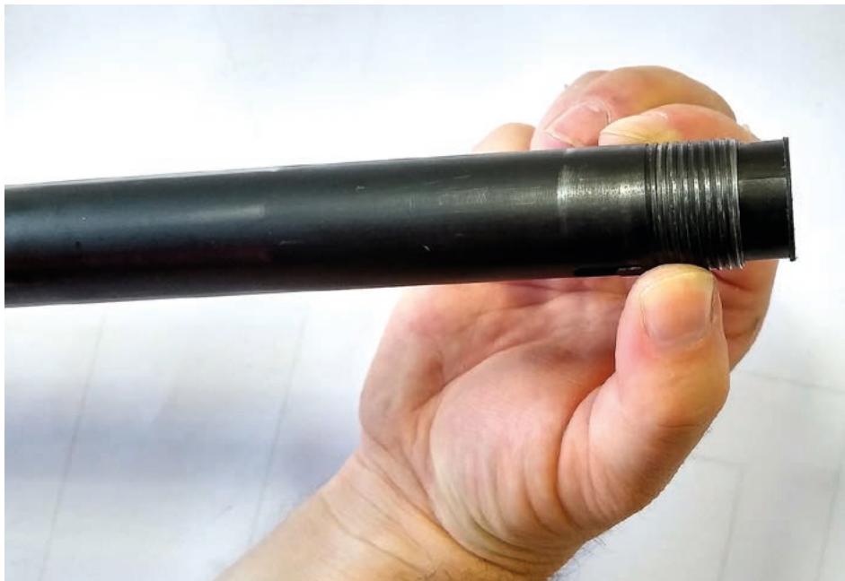
Fot. 25. Demontaż zaślepki rury magazynka
