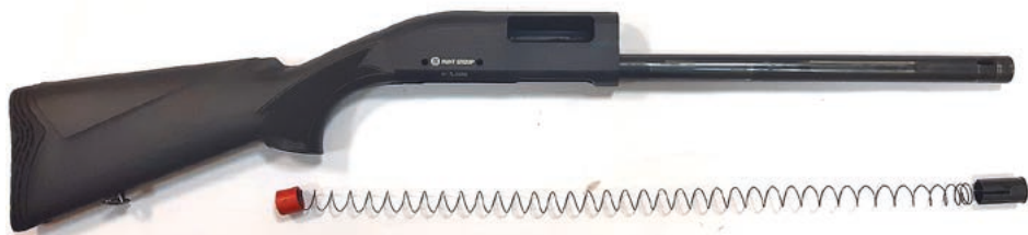
Fot. 14. Mechanizm zasilania z wyciągniętą sprężyną i donośnikiem koloru czerwonego, z prawej strony widoczna zaślepka magazynka
