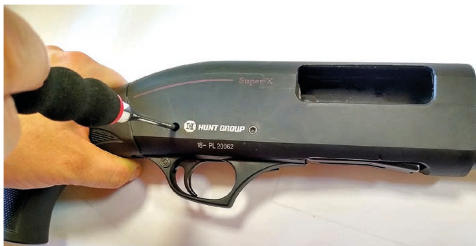
Fot. 23. Demontaż sworzni mechanizmu spustowo-uderzeniowego
