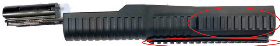
Fot. 4. Zespół przesuwny z założonym zamkiem i zaznaczonymi szynami montażowymi
