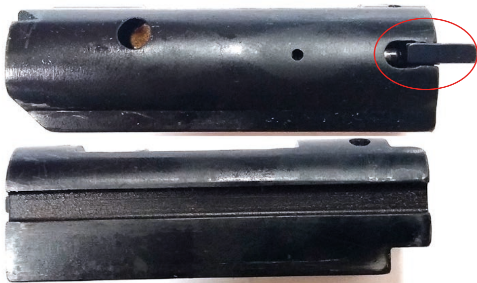
Fot. 7. Kompletny zamek - widok z prawej i lewej strony. Zaznaczony pazur wyciągu
