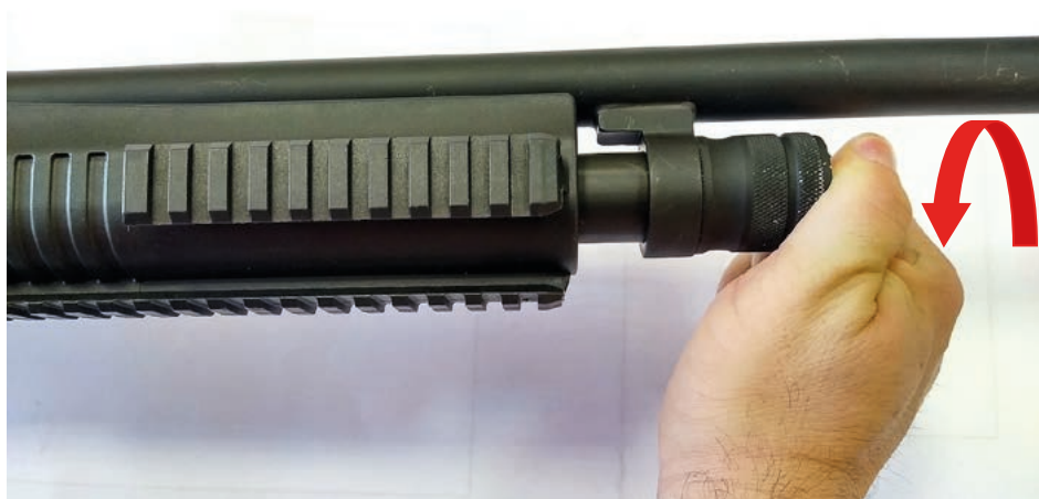
Fot. 19. Nakrętka mocującą lufę odkręcamy przeciwnie do ruchu wskazówek zegara
