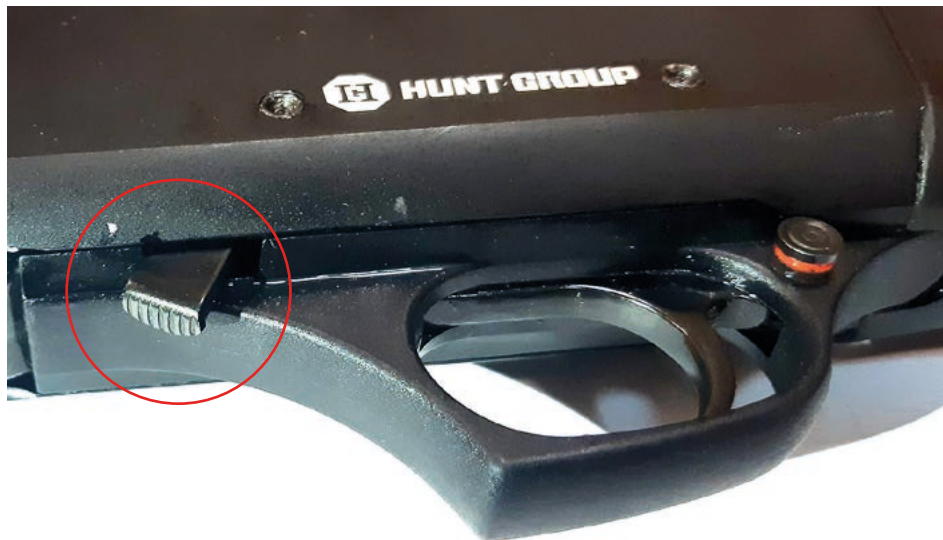
Fot. 12. Mechanizm spustowo-uderzeniowy przed kabłąkiem zaznaczony zatrask suwadła
