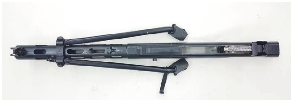
Fot. 17. Komora zamkowa z osłoną lufy, dwójnogiem i przyrządami celowniczymi
