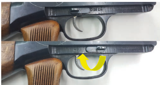
Fot. 24. U góry broń odbezpieczona, u dołu zabezpieczona
