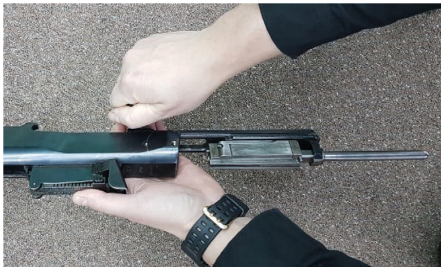
Fot. 30. Wyjęcie suwadła wraz z zamkiem i tłokiem
