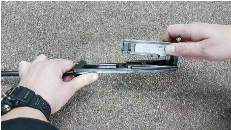
Fot. 31. Odłączenie zamka od suwadła poprzez jego uniesienie
