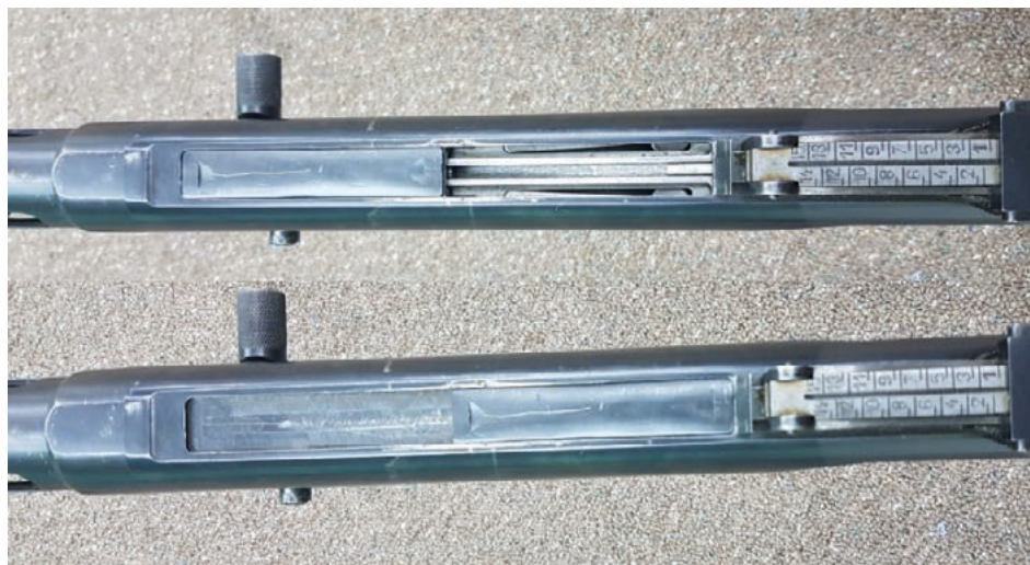
Fot. 9. U góry odsunięta osłona komory zamkowej, na dole zasunięta
