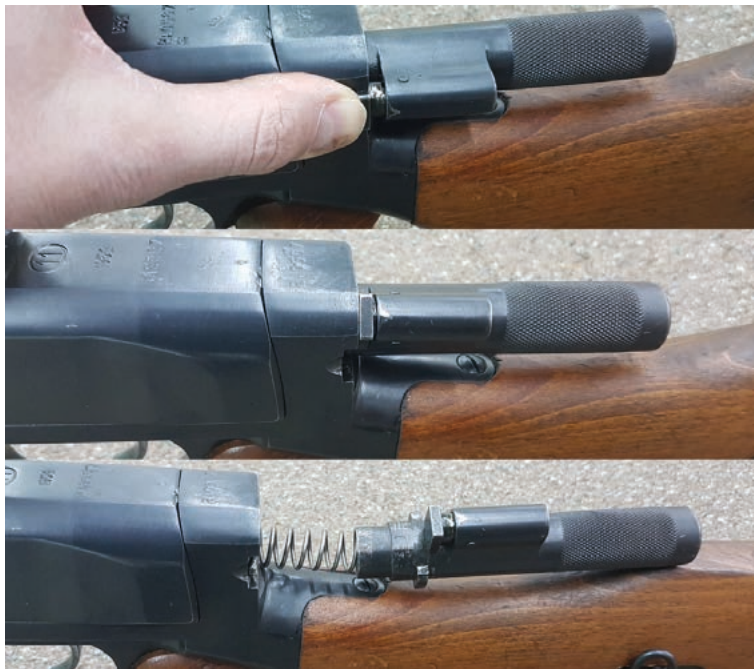
Fot. 27. Wyjęcie tulei powrotnej wraz ze sprężyną
