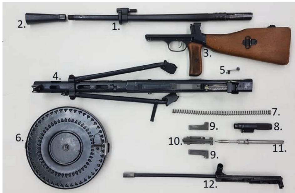
Fot. 35. Elementy karabinu: 1 – lufa; 2 – tłumik płomieni; 3 – kolba z komorą spustową i chwytem pistoletowym; 4 – komora zamkowa; 5 – śruba łącząca; 6 – magazynek; 7 – sprężyna powrotna; 8 – tuleja sprężyny powrotnej; 9 – rygle wahliwe; 10 – trzon zamka; 11 – iglica; 12 – suwadło z tłokiem
