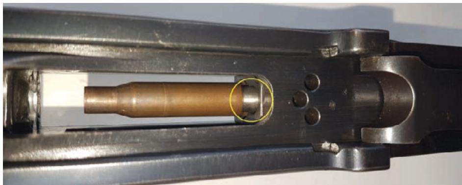
Fot. 12. Widoczny pazur wyciągu zaczepiony o kryzę łuski
