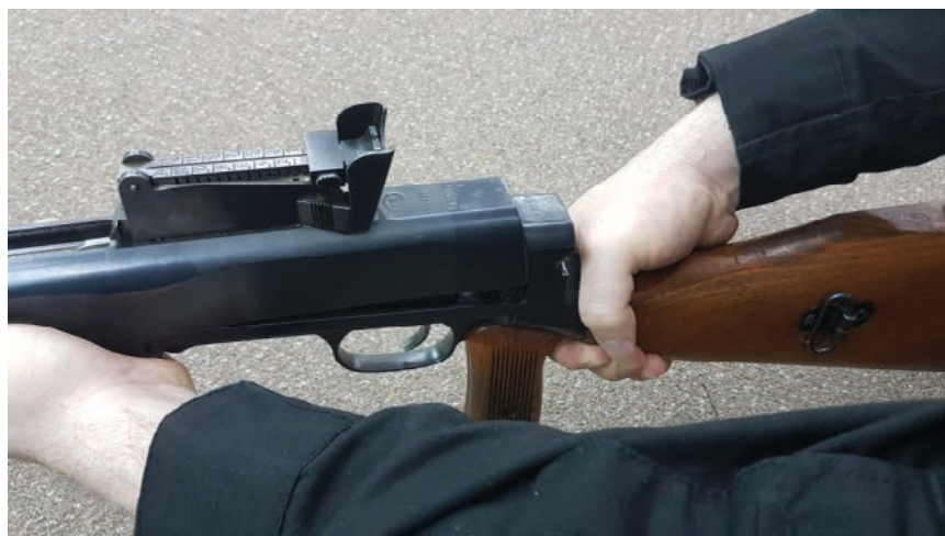
Fot. 29. Rozłączenie kolby z komorą spustową od komory zamkowej
