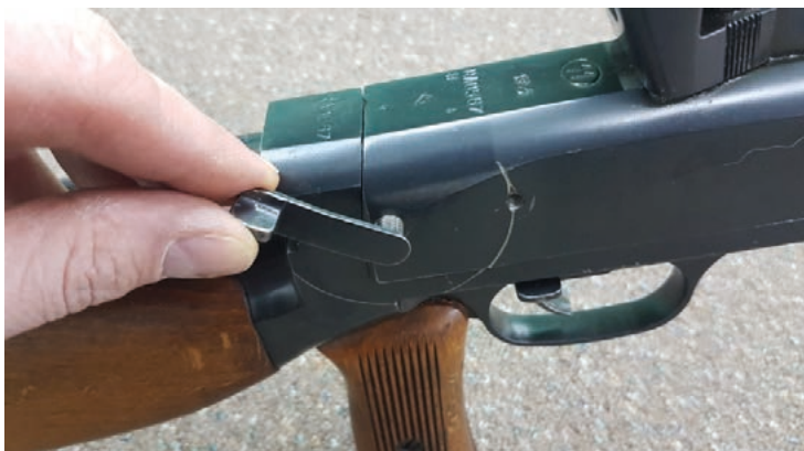
Fot. 28. Odkręcenie śruby łączącej
