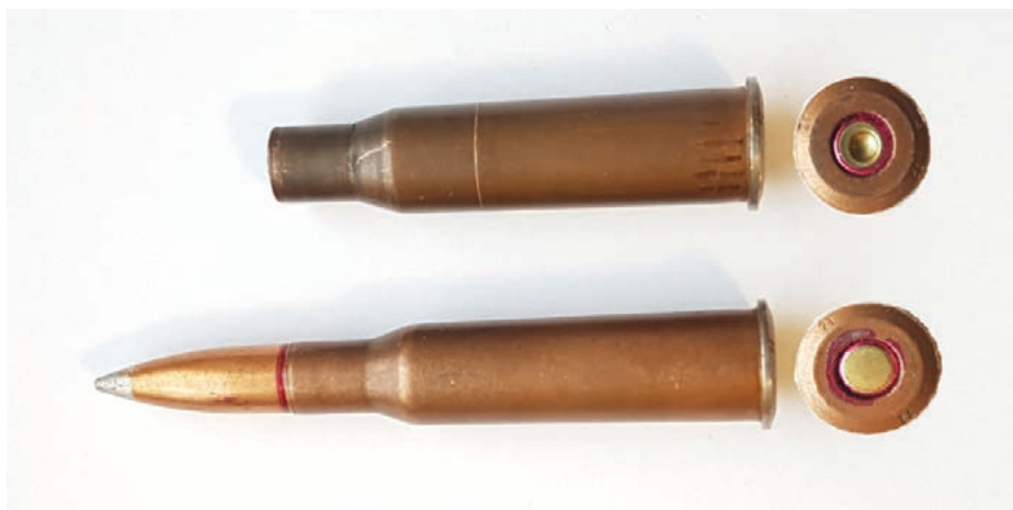
Fot. 7. Nabój z pociskiem ŁPS (pocisk lekki z rdzeniem stalowym), u góry łuska z widoczną zbitą spłonką
