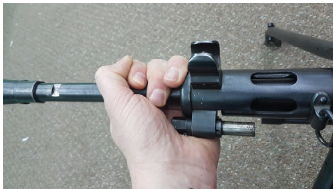
Fot. 34. Odłączenie lufy poprzez obrót w prawo
