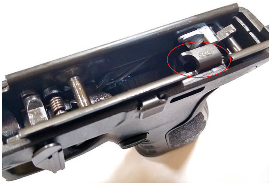
Fot. 13. Zaznaczony wyrzutnik łuski lub naboju w szkielecie szczątkowym (module spustowym)
