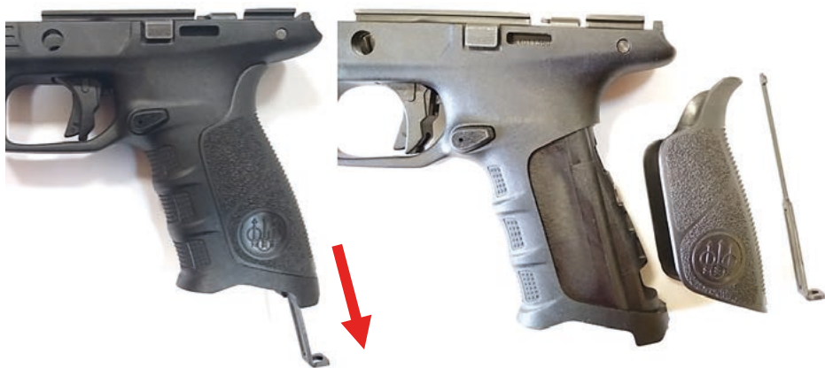
Fot. 35. Ustalczyk nakładki chwytu należy w całości wyciągnąć z obudowy, a następnie oddzielić nakładkę chwytu od obudowy szkieletu szczątkowego (modułu spustowego)
