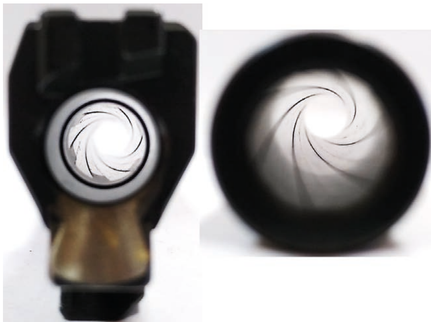
Fot. 10. Z lewej strony komora nabojowa, z prawej wylot lufy z widocznym gwintem
