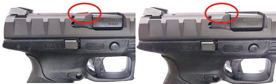
Fot. 23. Wskaźnik załadowania komory naboju, z lewej wprowadzony nabój, z prawej komora bez wprowadzonego naboju
