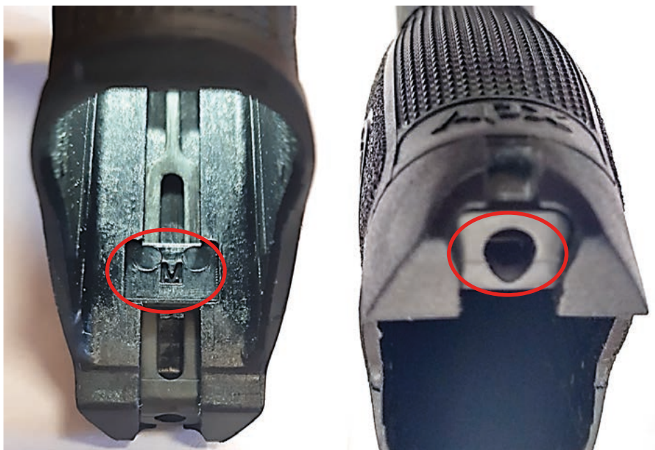
Fot. 32. Zaznaczone: rozmiar założonej nakładki chwytu (lewa strona), uchwyt do smyczy taktycznej (prawa strona)
