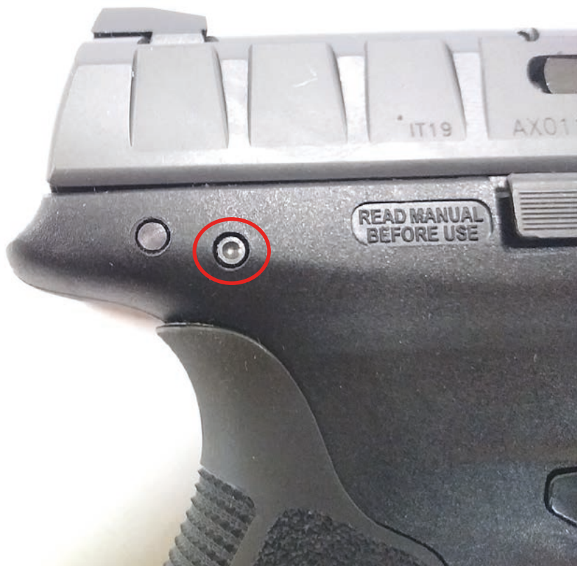
Fot. 22. Zaznaczony przycisk zwolnienia iglicy
