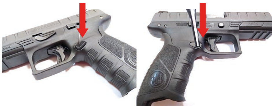
Fot. 36. Aby przystosować pistolet dla strzelca leworęcznego należy zacząć od demontażu sworznia zatrzasku magazynka (lewa strona), następnie należy zdemontować przycisk zatrzasku magazynka ze sprężyną (prawa strona) oraz wyjąć blokadę zatrzasku magazynka
