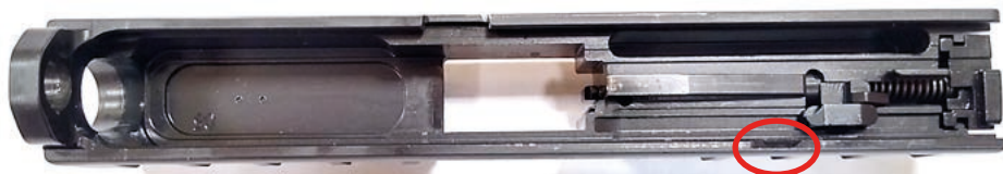
Fot. 20. Zaznaczone wycięcie w zamku, które umożliwia przesuwanie się szyny spustowej
