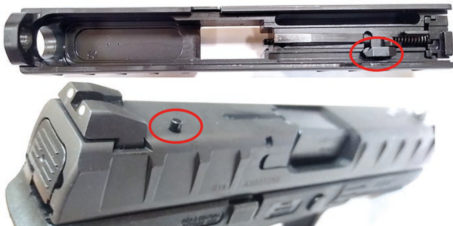
Fot. 19. Zaznaczona blokada iglicy, w trakcie ściągania języka spustowego unosi się element blokady (szczyt) widoczny w dolnej części zdjęcia
