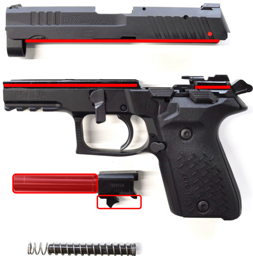
Fot. 5. Obszary w pistolecie REX zero 1 CP przeznaczone do nasmarowania
