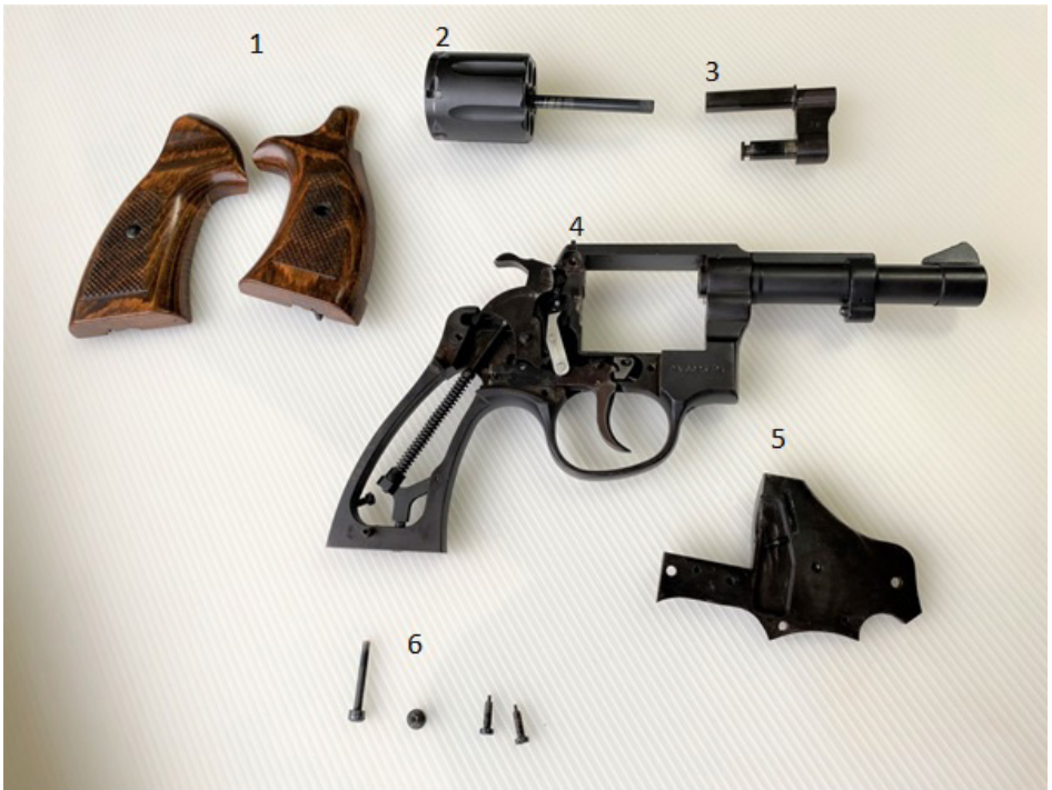
Fot. 3. GWARD 4" – rozłożony: 1. Okładziny chwytu; 2. Bęben; 3. Wysięgnik bębna; 4. Szkielet z lufą; 5. Pokrywa mechanizmu spustowego; 6. Wkręty mocujące
