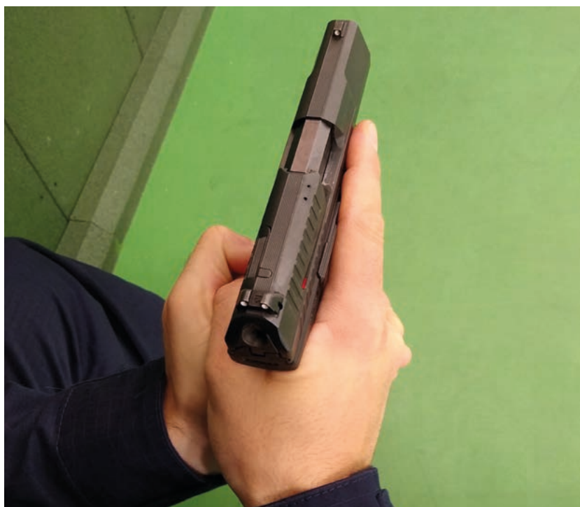
Fot. 8. Widoczny wskaźnik załadunku komory nabojeowej oraz zwolniona iglica
