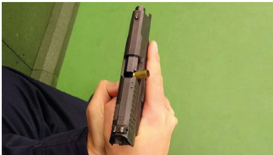
Fot. 39. Widoczna zakleszczona łuska w oknie wyrzutowym
