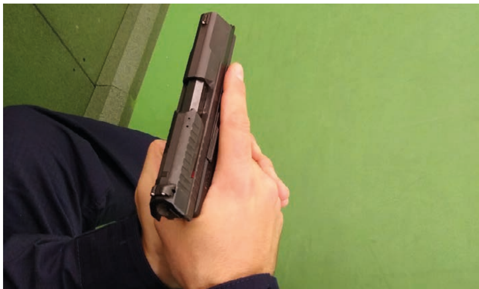
Fot. 18. Widoczne cofnięcie zamka i niezaryglowaną komorę naboju
