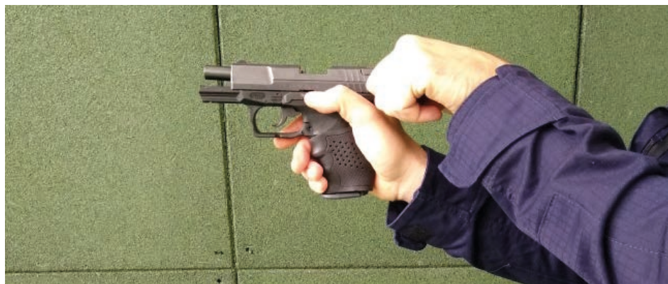
Fot. 49. Zatrzymanie zamka w tylnym położeniu w pistolecie wyposażonym w dźwignię zatrzymania/zwalniania zamka
