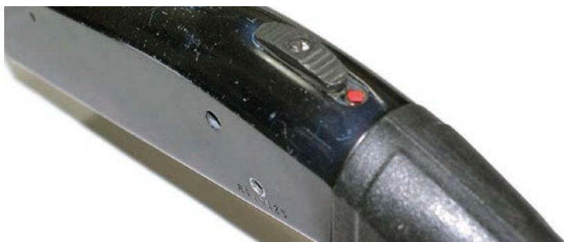
Fot. 79. Mossberg 500 A - widoczna czerwona cecha bezpiecznika (broń odbezpieczona)
