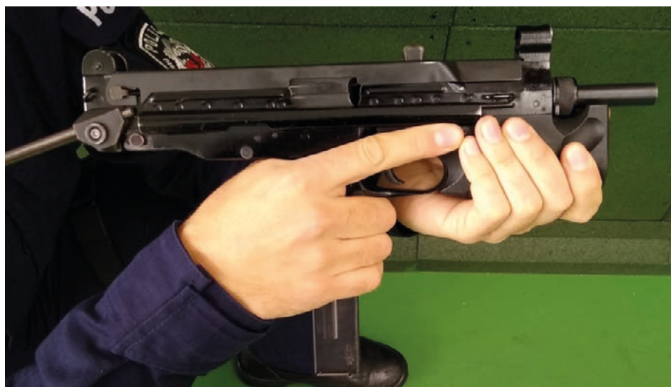
Fot. 60. W oknie wyrzutowym widoczny niezaryglowany zamek
