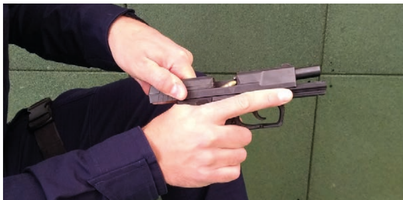
Fot. 31. Cofnięcie zamka o ok. 2-3 mm
