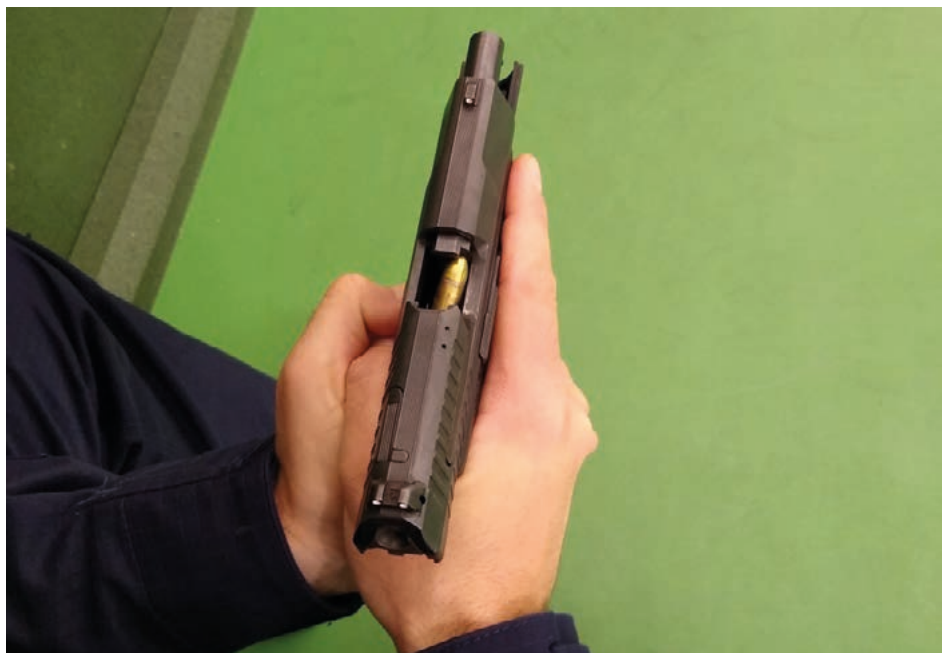
Fot. 29. Widoczne przekoszenie naboju w oknie wyrzutowym
