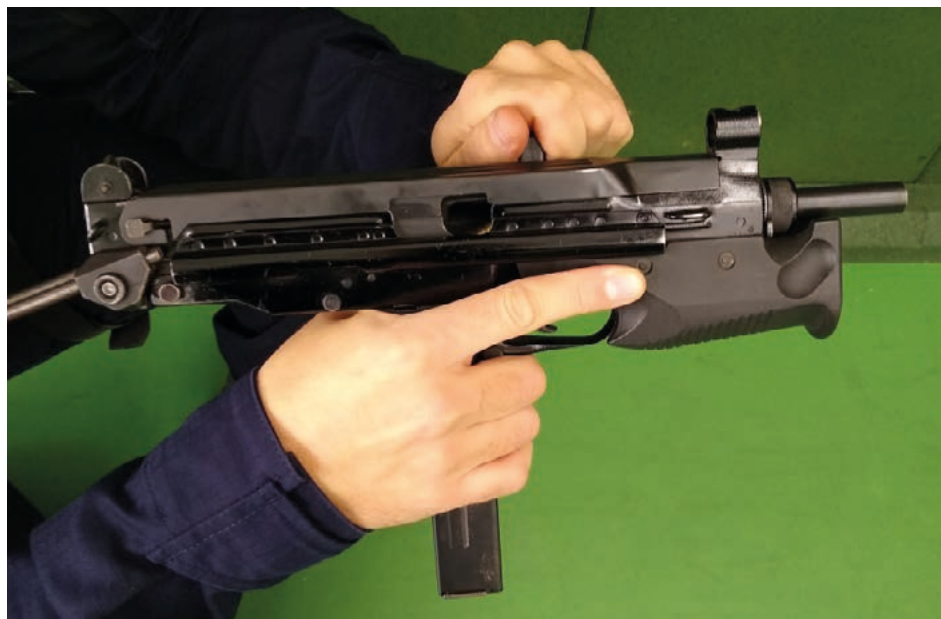
Fot. 66. Cofnięcie zamka o ok. 2-3 mm
