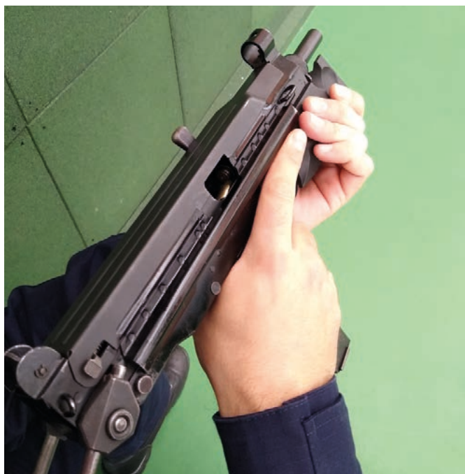
Fot. 75. W oknie wyrzutowym widoczne zablokowane względem siebie naboje
