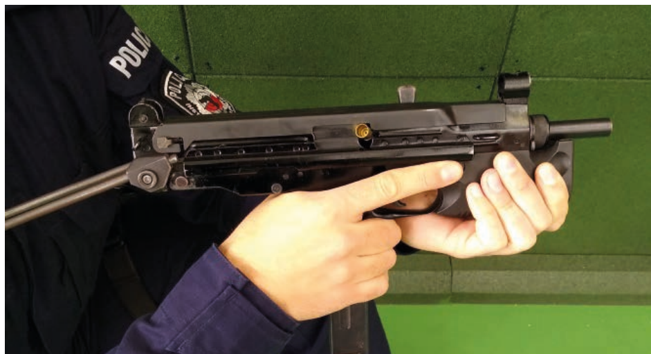
Fot. 70. Widoczna zakleszczona łuska w oknie wyrzutowym
