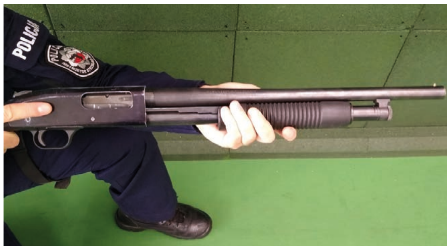
Fot. 81. Widok na okno wyrzutowe
