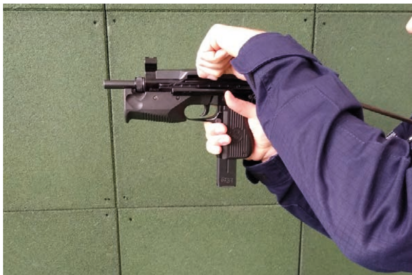
Fot. 76. Zatrzymanie zamka w tylnym położeniu za pomocą dźwigni zatrzymania/zwalniania
