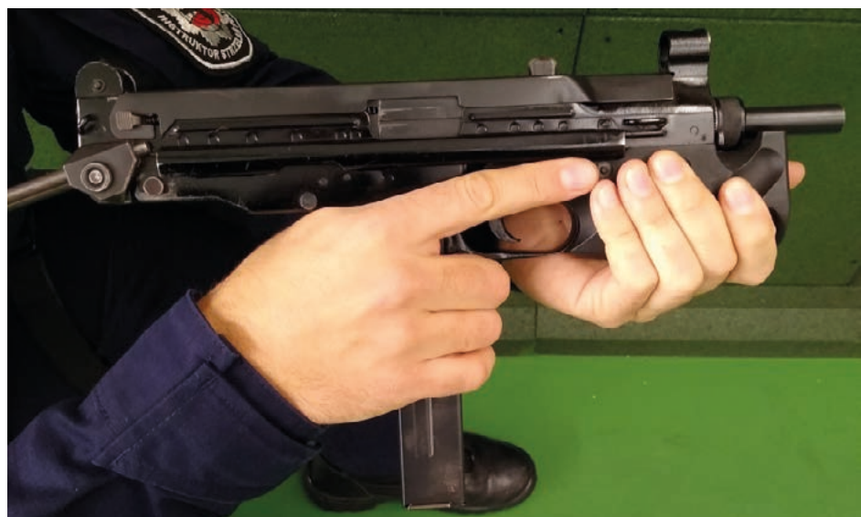
Fot. 54. Przez okno wyrzutowe łusek widoczny prawidłowo zaryglowany zamek
