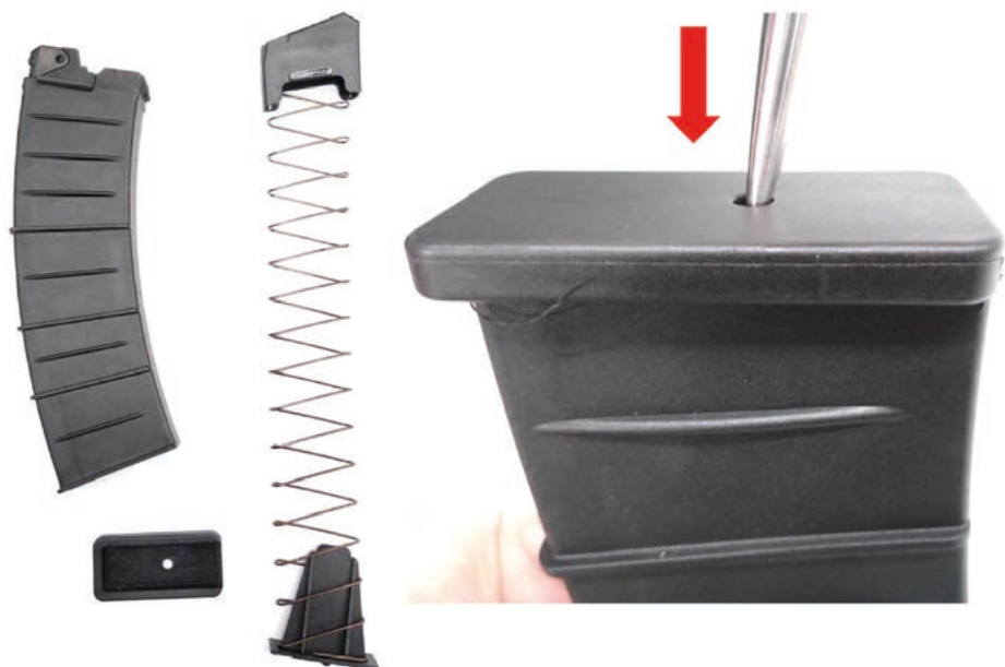
Fot. 39. Z lewej strony rozłożony magazynek, z prawej widoczny demontaż zatrzasku dna magazynka
