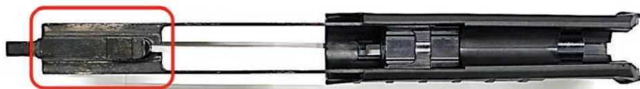
Fot. 16. Zespół przesuwny - widok z góry, zaznaczona ramka suwadła
