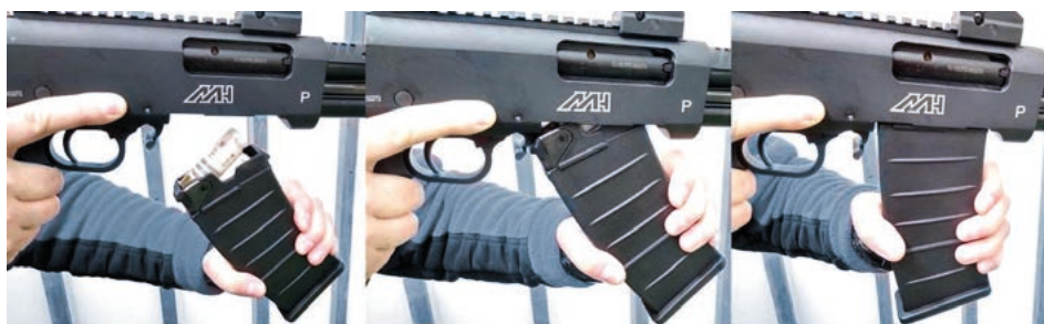
Fot. 30. Podłączenie magazynka w strzelbie zamkniętej
