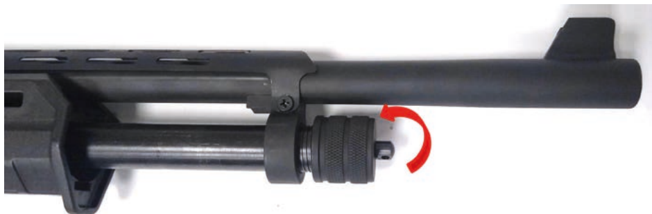
Fot. 35. Nakrętkę mocującą lufę odkręcić przeciwnie do ruchu wskazówek zegara
