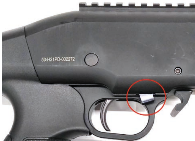
Fot. 26. Zaznaczony zatrask suwadła
