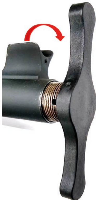
Fot. 13. Wkręcanie czoka kluczem zgodnie z ruchem wskazówek zegara
