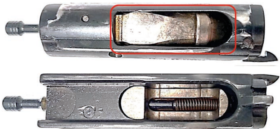
Fot. 18. Kompletny zamek - widok od góry i od dołu, zaznaczony rygiel
