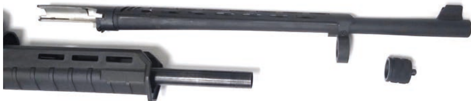
Fot. 36. Wysunięcie lufy i oddzielenie lufy od komory zamkowej
