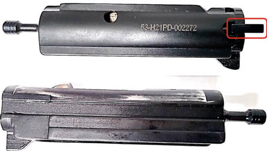
Fot. 17. Kompletny zamek - widok obu stron, zaznaczony pazur wyciągu
