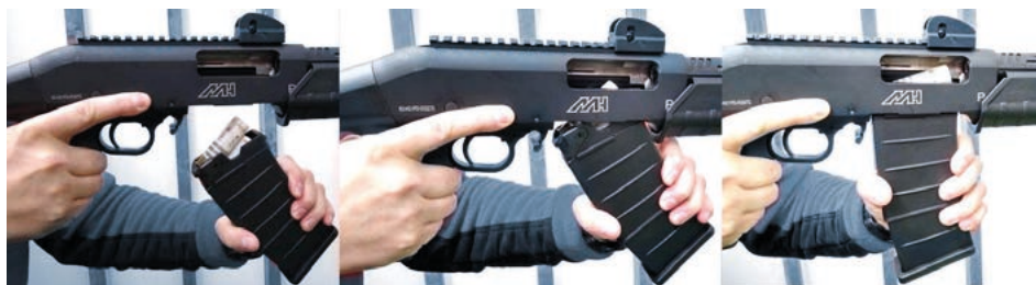
Fot. 29. Podłączenie magazynka w strzelbie otwartej
