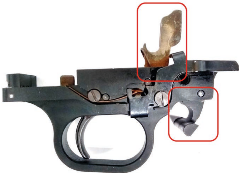
Fot. 25. Mechanizm spustowo-uderzeniowy z zaznaczonym kurkiem - u góry, oraz zatrzaskiem magazynka - u dołu
