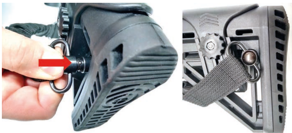
Fot. 42. Sposób montażu tylnego końca pasa nośnego do kolby
