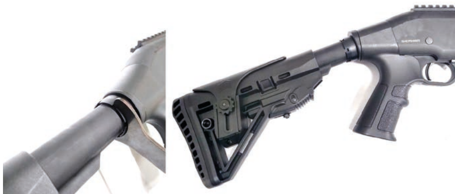
Fot. 24. Za pomocą dołączonego klucza odkręca się pierścień mocujący kolbę i montuje ją w sposób obniżony
