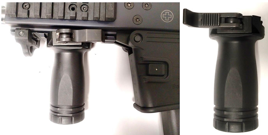
Fot. 9. Z lewej strony widoczny uchwyt pasa nośnego oraz zamontowany chwyt przedni, z prawej strony sam chwyt
