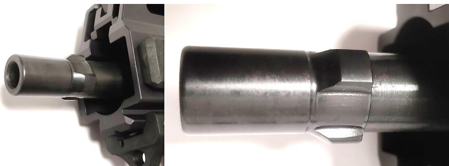
Fot. 11. Wylot lufy z widocznym złączem tłumika
