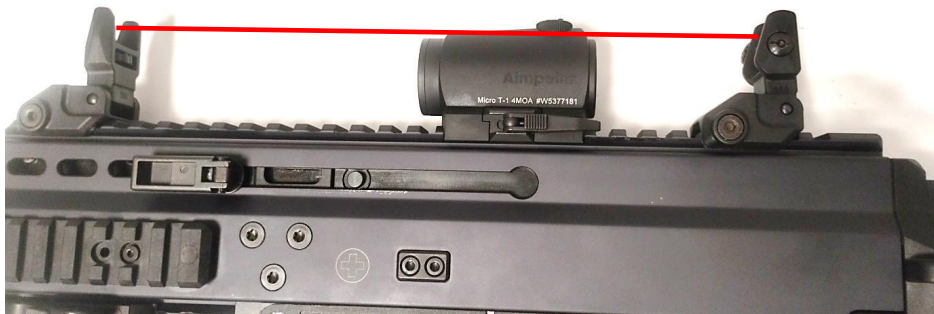
Fot. 8. Widoczny za nisko osadzony kolimator względem linii celowniczej (czerwona prosta) mechanicznych przyrządów celowniczych
