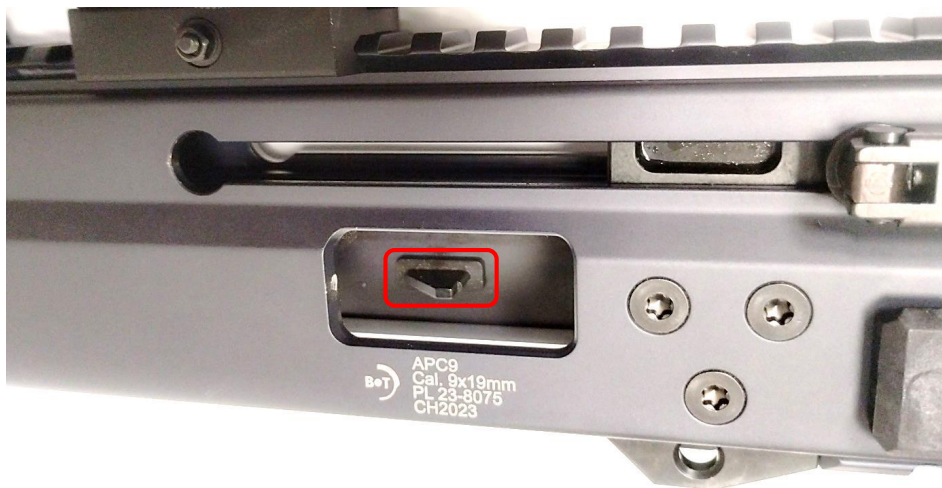
Fot. 10. Widoczne okno wyrzutu łuski lub naboju z zaznaczonym wyrzutnikiem, powyżej wycięcie i złożona dźwignia przeładowania (napinacz)
