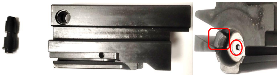
Fot. 17. Widok zamka wraz z trzpieniem zabezpieczającym, po prawej zaznaczony pazur wyciągu i grot iglicy
