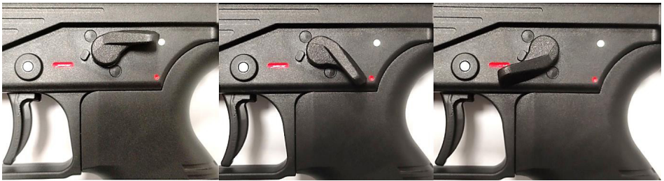
Fot. 14. Komora spustowa z przełącznikiem (bezpiecznikiem) rodzaju ognia, od lewej zabezpieczony – biała cecha, po środku ogień pojedynczy – czerwona cecha, po prawej ogień ciąży – podłużna, czerwona cecha
