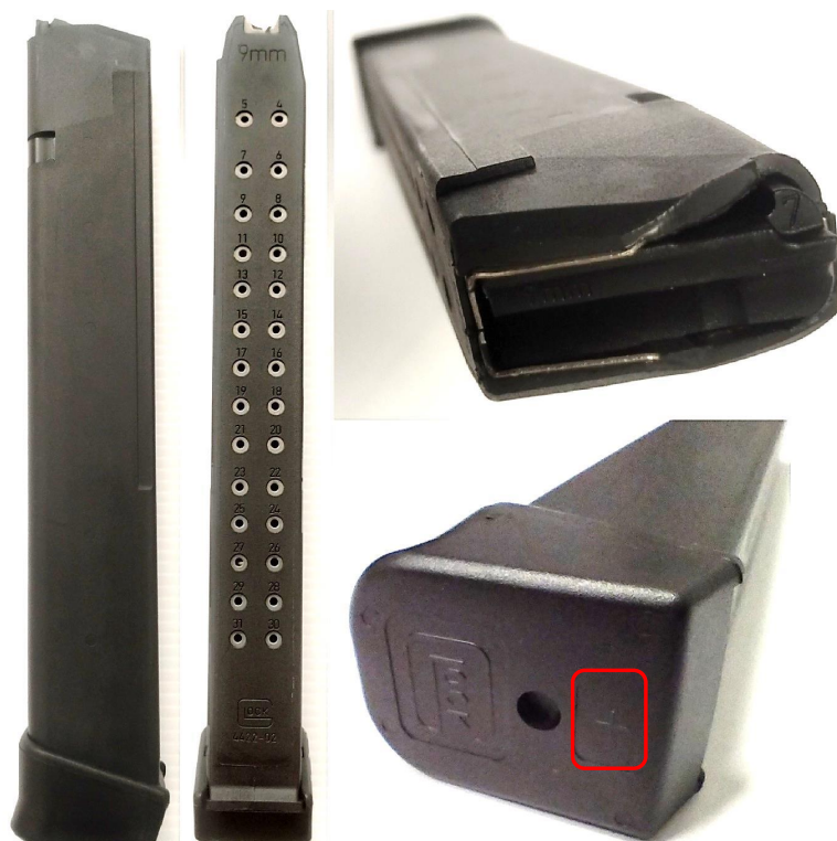
Fot. 21. Magazynek z widocznymi wskaźnikami załadowania, w prawym górnym rogu donośnik magazynka koloru czarnego poniżej powiększone denko magazynka oznaczone symbolem „+” (zaznaczone)
