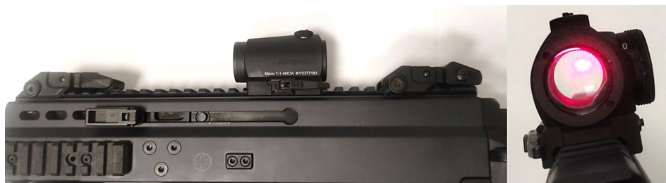
Fot. 6. Widok zainstalowanego kolimatora na szynie montażowej, z prawej strony widoczna czerwona kropka celownika
