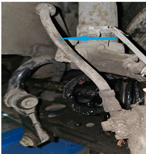
Fot. 13. Uszkodzenie przewodów hamulcowych
