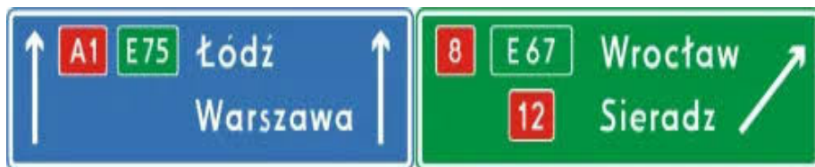
Drogowskaz tablicowy umieszczany nad jezdnią na autostradzie E-2d
