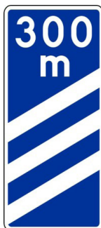
Tablica wskaźnikowa na autostradzie umieszczana w odległości 300 m przed pasem wyłączenia F-14a
