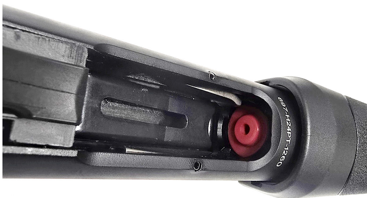
Fot. 20. Donośnik naboju koloru czerwonego ułatwia strzelcowi rozpoznanie stanu załadowania broni
