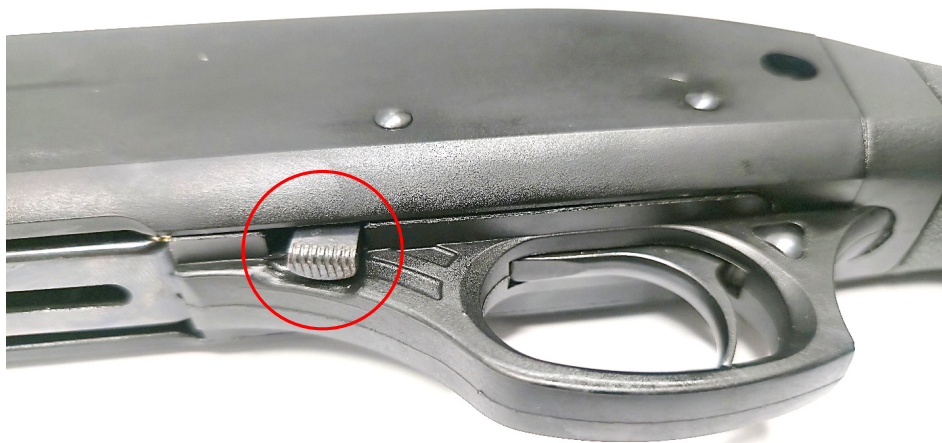
Fot. 16. Mechanizm spustowo-uderzeniowy, przed kabłąkiem zaznaczony zatrask suwadła
