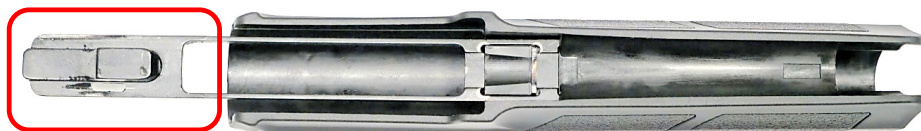
Fot. 7. Zespół przesuwny – widok z góry, zaznaczona ramka suwadła
