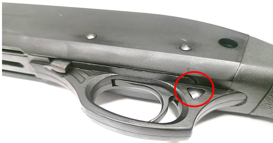
Fot. 18. Widok zabezpieczonego bezpiecznika
