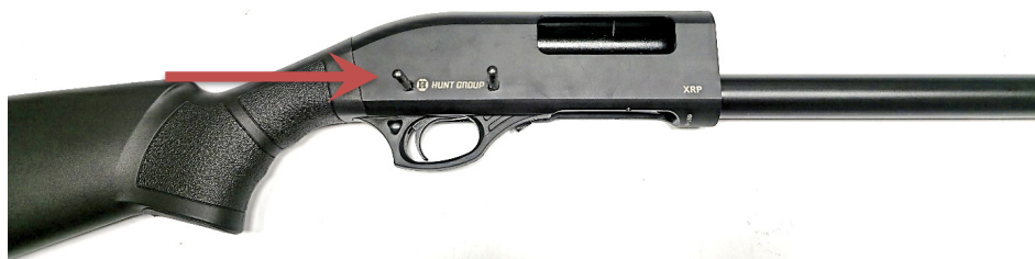
Fot. 29. Demontaż sworzni mechanizmu spustowo-uderzeniowego
