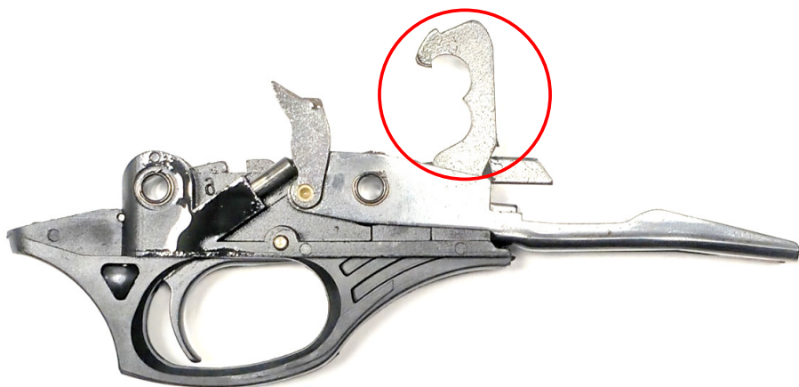
Fot. 15. Mechanizm spustowo-uderzeniowy z zaznaczonym kurkiem
