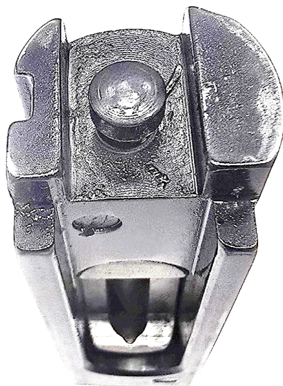
Fot. 12 i 13. Kompletny zamek – widok od przodu i od tyłu, zaznaczony grot iglicy
