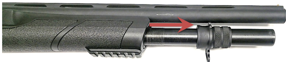
Fot. 24 i 25. Nakrętkę mocującą odkręcamy przeciwnie do ruchu wskazówek zegara, następnie ściągamy ją przesuwając w kierunku zakończenia lufy
